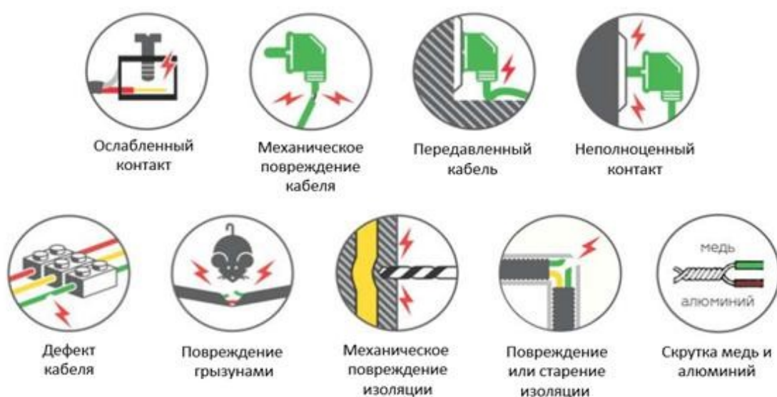
Рисунок 6. Возможные причины искрения в электропроводке
